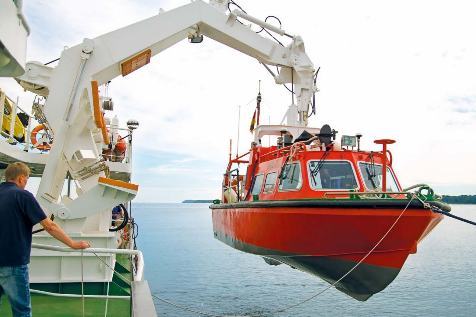
Das Vermessungsboot POLLUX ist unter anderem mit einem Vertikalecholot, Seitensichtsonar und Fächer-echolot ausgestattet. Die Vermessungsergebnisse erreichen Genauigkeiten im Zentimeterbereich.
