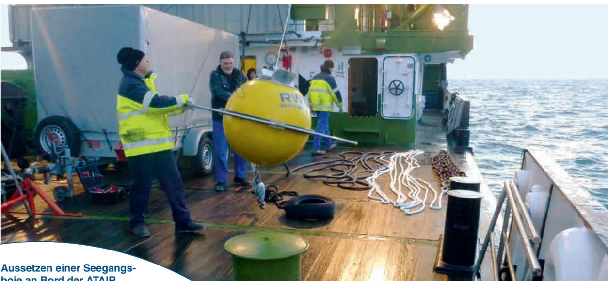
Aussetzen einer Seegangsböje an Bord der ATAIR
