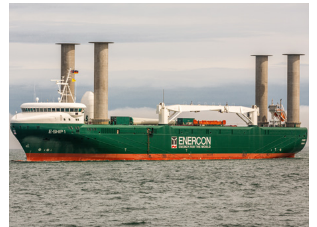
Innovativer Zusatzantrieb: Das unter Deutscher Flagge fahrende Frachtschiff »E-Ship 1« spart durch Flettner-Rotoren bis zu 25 Prozent Treibstoff ein
