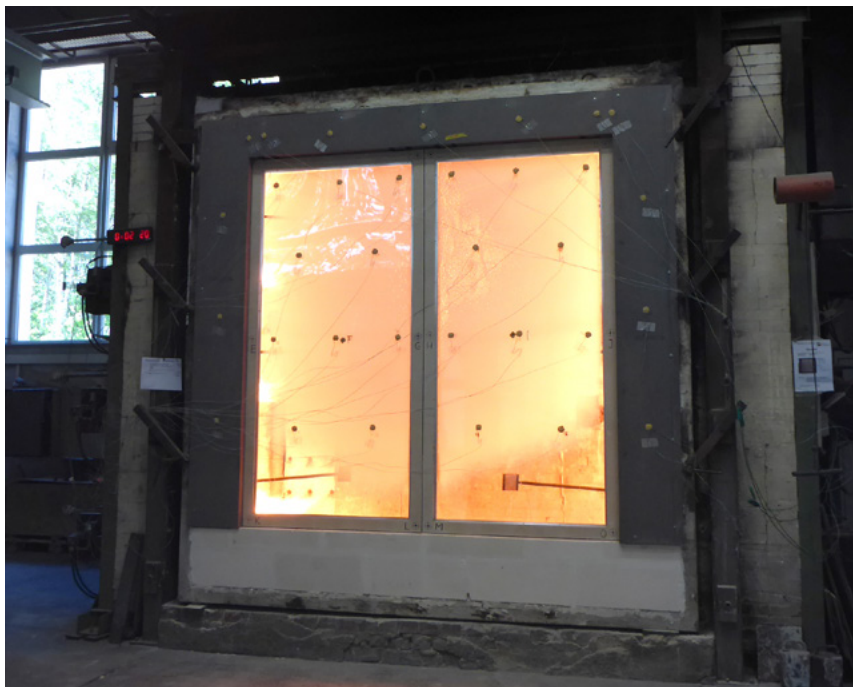
Türen beim Brandversuch: Feuer und Flamme für die Schiffssicherheit
