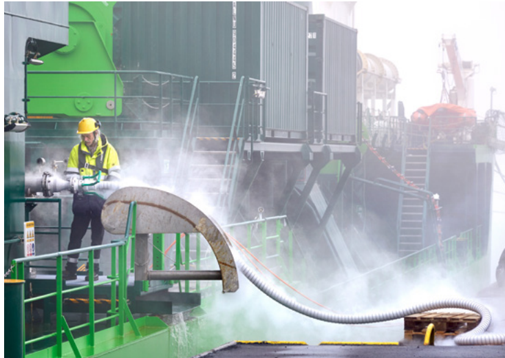
Eiskalt in den Tank: LNG-Bunkering im Elbehafen Brunsbüttel
