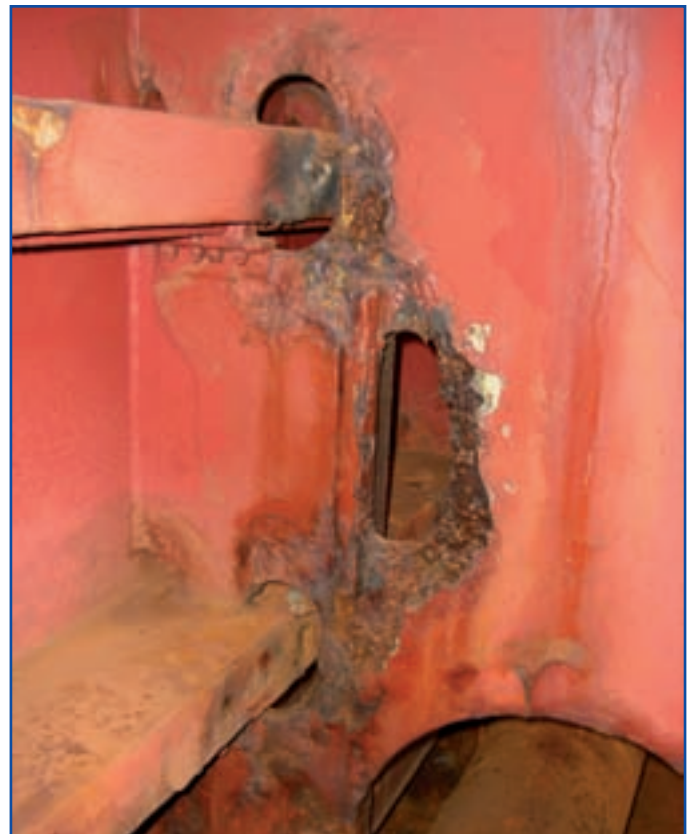
Durchrostung von Schiffsverbänden
