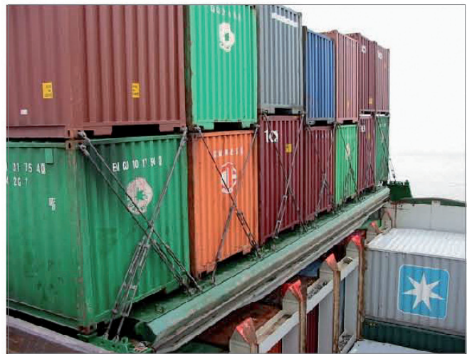
Abbildung 2.2: Zellengerüste und Zurrstangen auf einem Containerschiff
