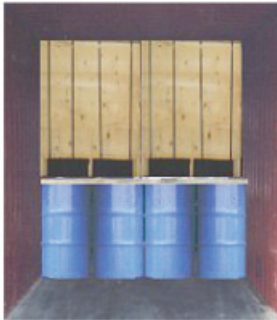
Abbildung 7.27: Gemischte Stauung, trockene über nassen Gütern
