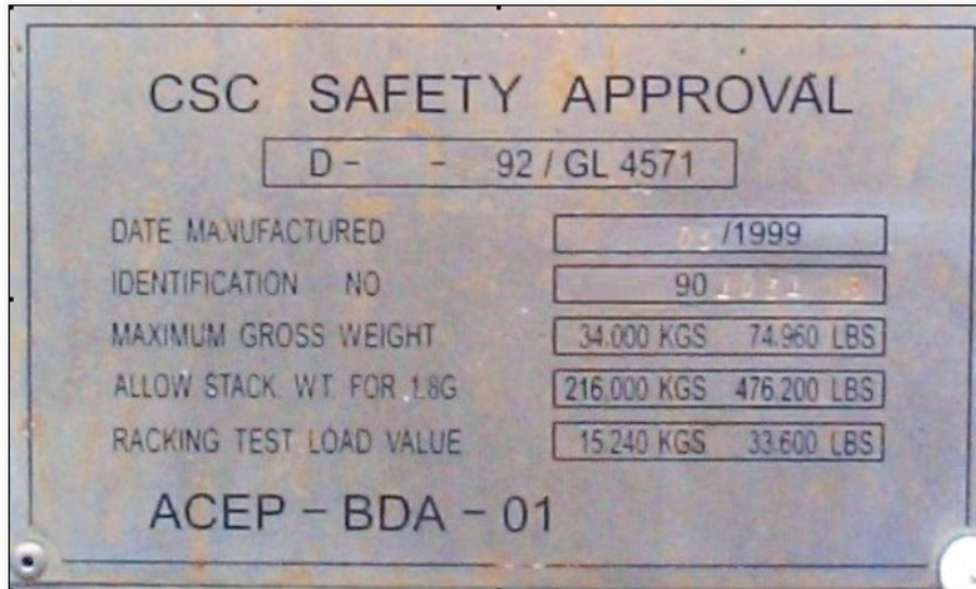
Abbildung 4.3: CSC-Sicherheits-Zulassungsschild mit ACEP-Kennzeichen
