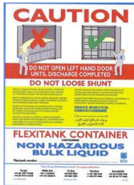
Abbildung 5.17: Kennzeichnung von flexiblen Tankbehältern
