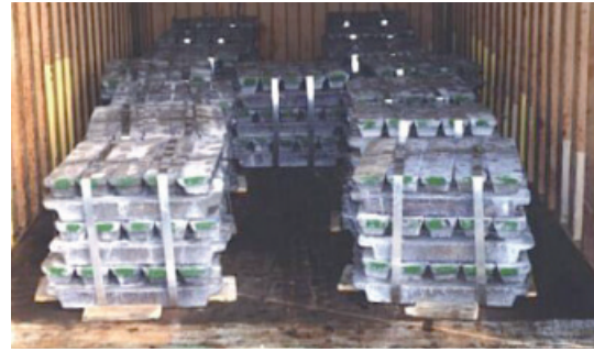
Abbildung 7.19: Mit Stahlbändern zusammengefasste Metallbarren (nicht abgeschlossene Sicherung)
