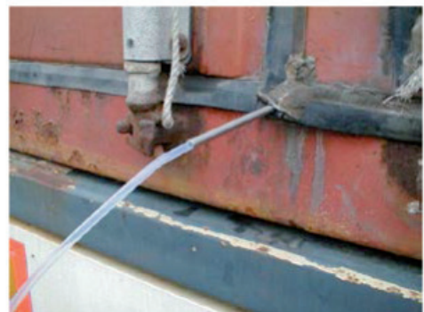
Abbildung 5.21: Entnahme einer Gasprobe
