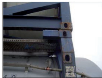
Abbildung 4.9: Rücksprung mit sekundärer seitlicher Hebeöffnung
