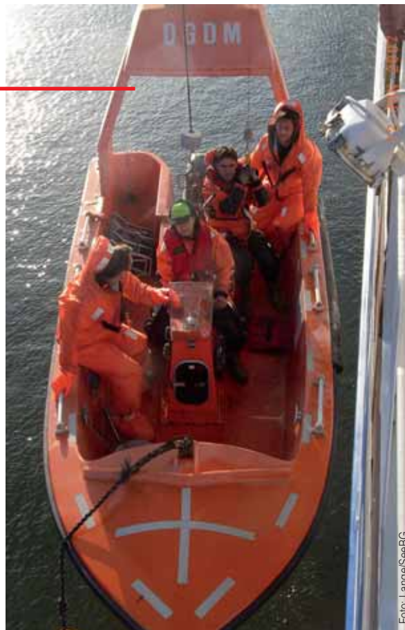
Schnelles Bereitschaftsboot auf RoRo-Fahrgastschiffen
