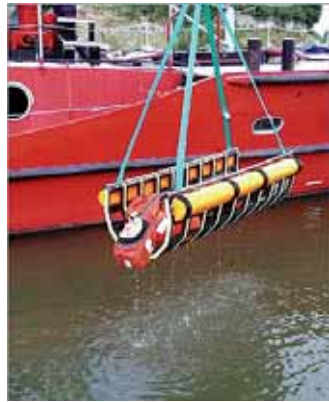
»Jasons Cradle« am Kran, rechts in gestautem Zustand Fotos: SeeBG/Lange
