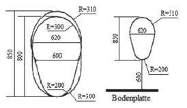
3 Befindet sich eine senkrechte Öffnung in einer Höhe von mehr als 600 mm über einer Stufe, so sind Handgriffe vorzusehen. Bei solchen Anordnungen muss nachgewiesen werden, dass eine verletzte Person leicht evakuiert werden kann.
