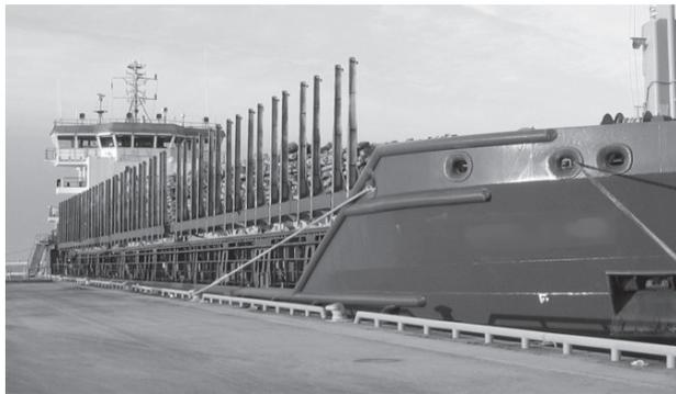
**Abbildung 6.9** Stützen für die Verblockung über die gesamte Höhe des Stauverbandes
